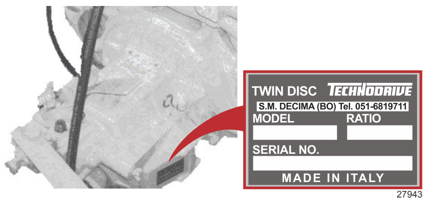
Plaque signalétique de la transmission Technodrive TM 345
